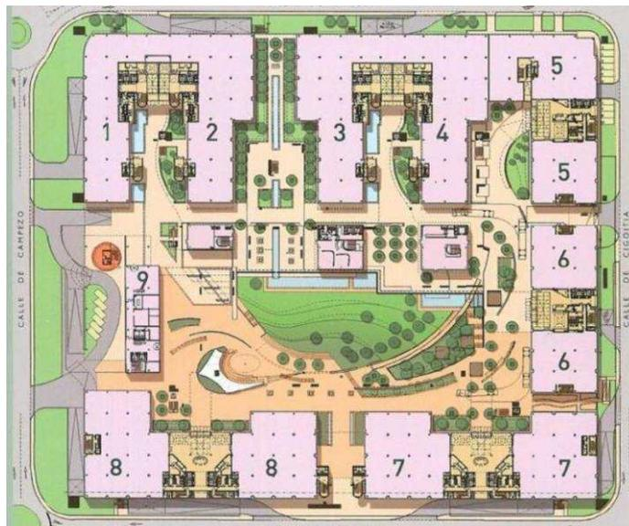
Cada edificio, a excepción del 9, tiene cinco plantas sobre rasante (planta baja y cuatro plantas), con dos niveles en sótanos y un nivel de cubierta para instalaciones y locales técnicos. La planta baja cuenta con un hall a doble altura con zonas de espera, recepción y despachos de control del edificio.
